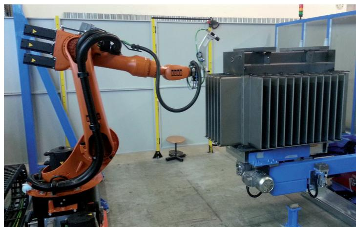
Fig\_02: Fase di scansione con sistema laser per ricerca percorso di saldatura pareti.
