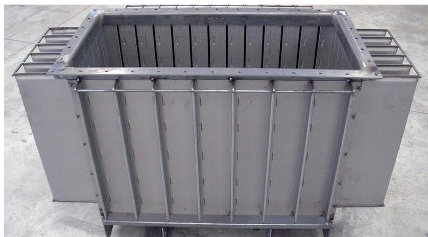
Fig\_03: Il processo di sviluppo della cassa trasformatore da saldare è stato ristudiato e ottimizzato da Proquadro con benefici ottenuti anche in termini di migliore qualità del prodotto finito.
