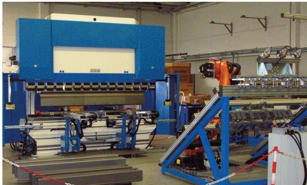
La cella integra un robot antropomorfo Kuka e una pressa di piegatura da 3 m e 330 t.
